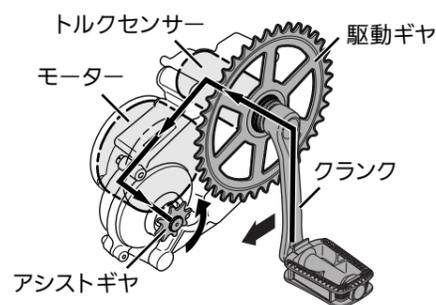
ペダルの踏力を、クランクを通じてトルクセンサーで感知し、最適なアシスト力をモーターからアシストギヤへ伝えることにより、快適なアシスト走行を実現しています。
