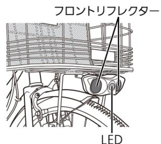
反射面が地面および前車輪に対して直角になっているか確認してください。
