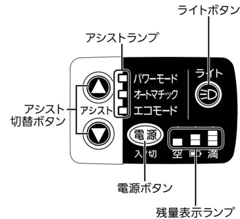
※電源ボタンまたはライトボタン「入」のとき、バックライトが点灯し、夜間走行時もボタン操作がしやすくなっています。(以下「手元スイッチ」)
