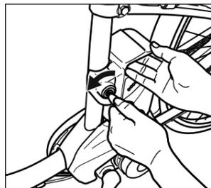
バッテリーを支え、バッテリーロックキーを反時計方向に 60 度回す。
