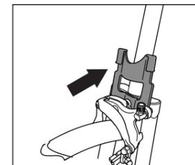
車両転倒時、ハンドルが切れすぎて、フレームにパーツがあたり、損傷するのを防ぎます。
