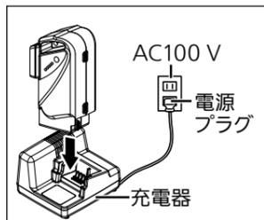
電源プラグをコンセント(AC100 V)に差し込み、バッテリーを充電器に奥まで押し込む。
