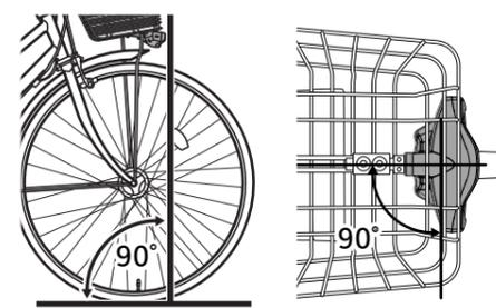
反射面が地面および前車輪に対して直角になっているか確認してください。
