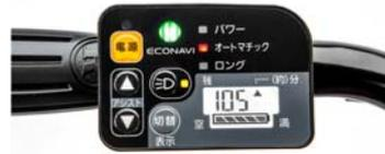
バッテリー残量表示機能を搭載した手元スイッチ
